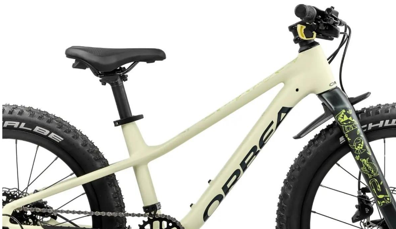
Lekka rama aluminiowa z wewnętrznym prowadzeniem linek
