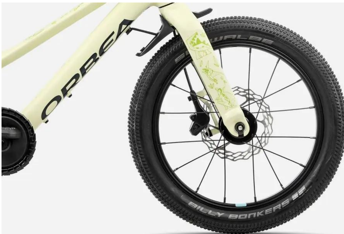
Widelec zintegrowany z błotnikiem i stabilizatorem
